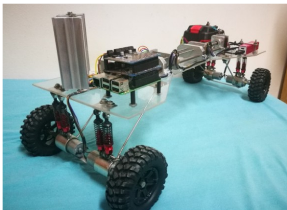
Obr. 9. Reálna konštrukcia RC vozidla s nastaviteľným podvozkom
