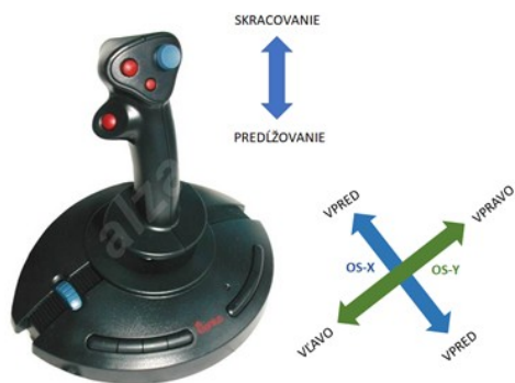
Obr. 8. Externý joystick Genius a zobrazenie ovládania vozidla [8]
