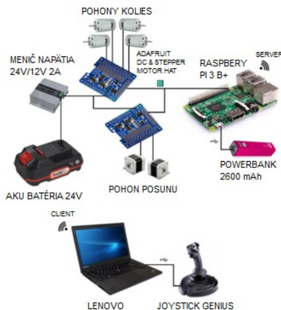
Obr. 1. Bloková schéma prepojenia reálnych komponentov elektroniky RC vozidla s posunom podvozku
