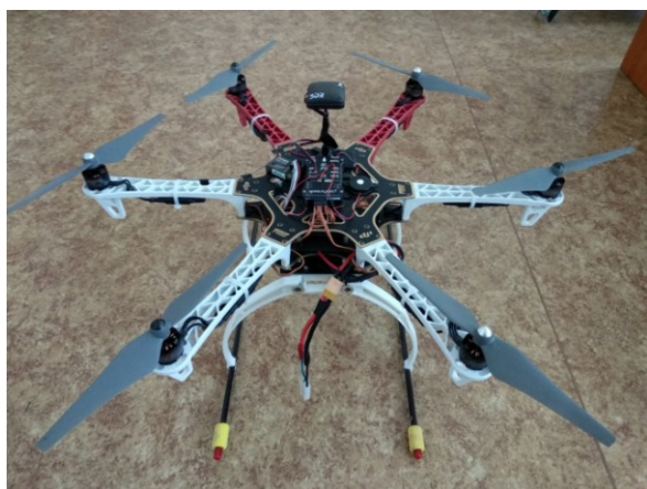
Obr. 5 Umiestnenie Pixhawk spolu s GPS modulom
