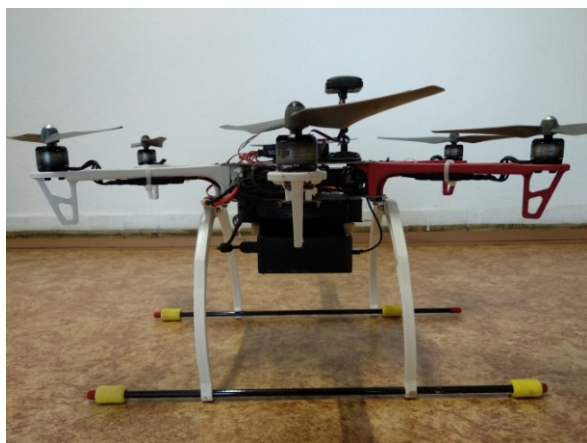
Obr. 4 Umiestnenie počítača na šasi drona
