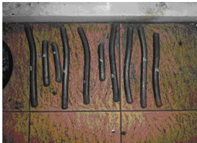
Obr. 7. Vzorok odstrihnutých začiatkov na CVS02 pred úpravami riadenia. Rozptyl je 15 cm - 25 cm.
