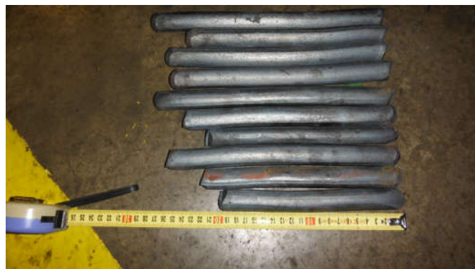
Obr. 6. Vzorok odstrihnutých začiatkov na CVS02 po úprave riadenia. Rozptyl je približne 8cm.
