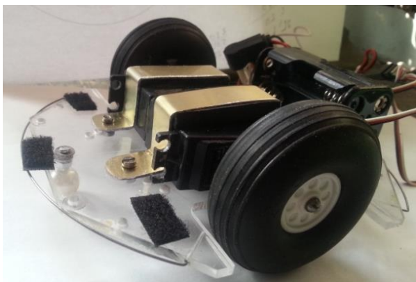
Obr. 1. Upevnenie hnacieho kolesa s motorom
