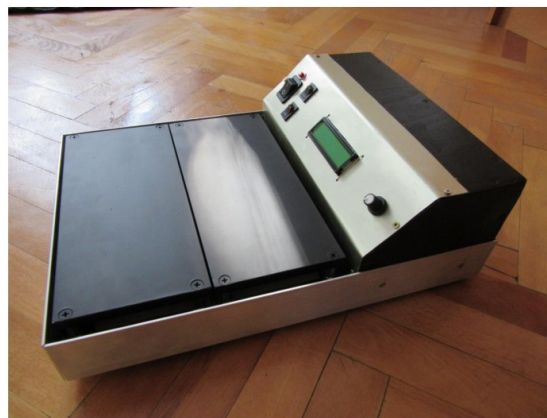
Obr. 6. Vyhrievaná podložka na predohrev dosiek plošných spojov [5]
