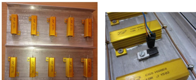
a) rozmiestnenie výkonových rezistorov na výhrevných doskách
