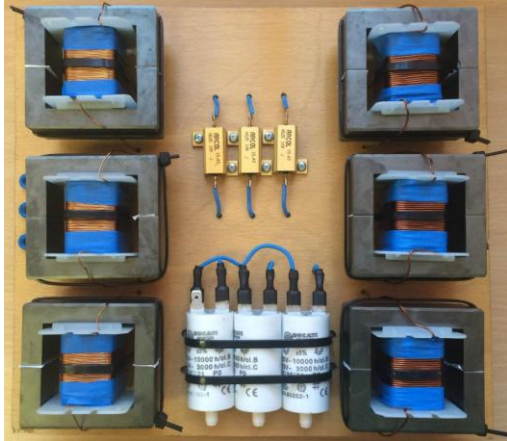
Obr. 6. Laboratórny model trojfázového LCL filtra s pasívnym filtrom
