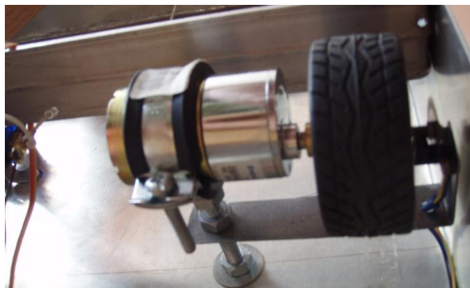
Obr. 4. Upevnenie hnacieho motora s kolesom
